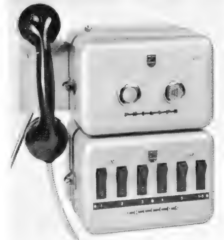
Sprechstelle einer neuartigen Betriebsrufanlage von Philips mit Handapparat, Transistorverstärker (oben) und Schalterkasten
